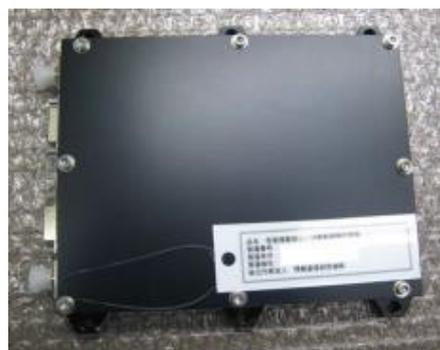
図2 超小型理学観測衛星ライズサット搭載VSOTAのレーザー光源
