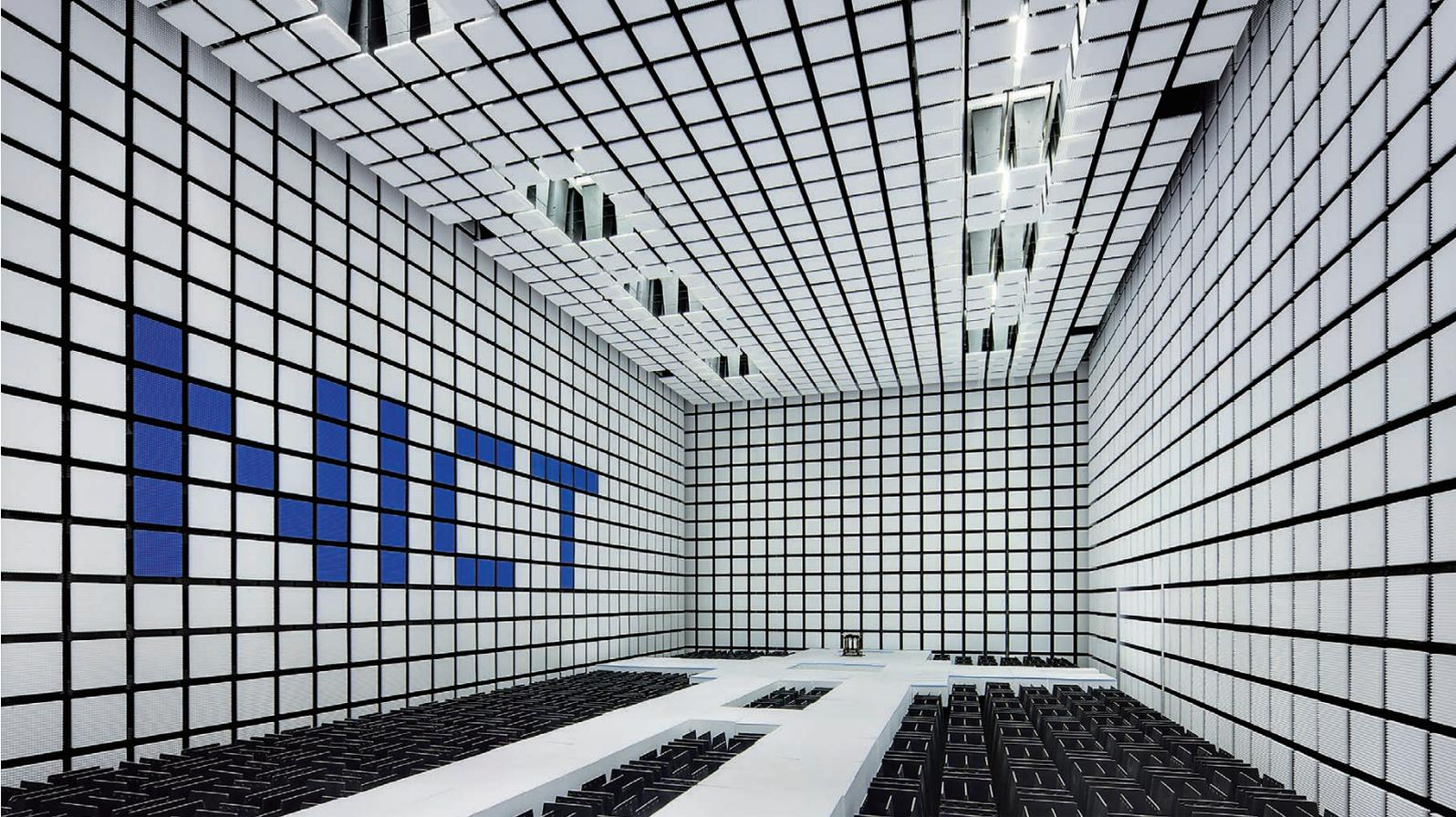
大型電波無響室：様々な波長の電波（30 MHz～40 GHz）に対して精密な測定を行うために広い空間を確保し、室内での電波の反射を防止した実験設備（床にも吸収体を敷設した6面暗室（写真）の状態、D23.4m×W11.9m×H7.9m（内壁間））
