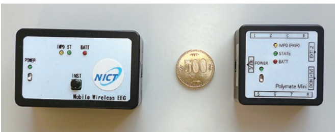
図3 開発した小型の脳波計の計測部(左)とこれを元にして製品化された脳波計の計測部(右)。脳波を計測するときにはこの計測部に電極をつなぎ、その電極を頭に付着させる
