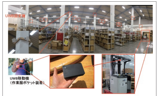
図5 物流倉庫での固定機配置と移動機装着例
