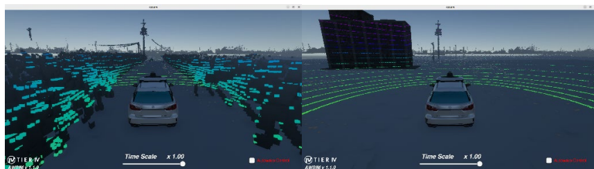
シミュレーター上で自動運転中にLiDarでデータを収集している様子
