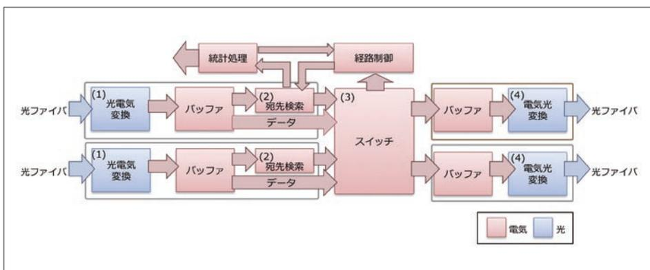
図1 インターネットルータの内部構造
