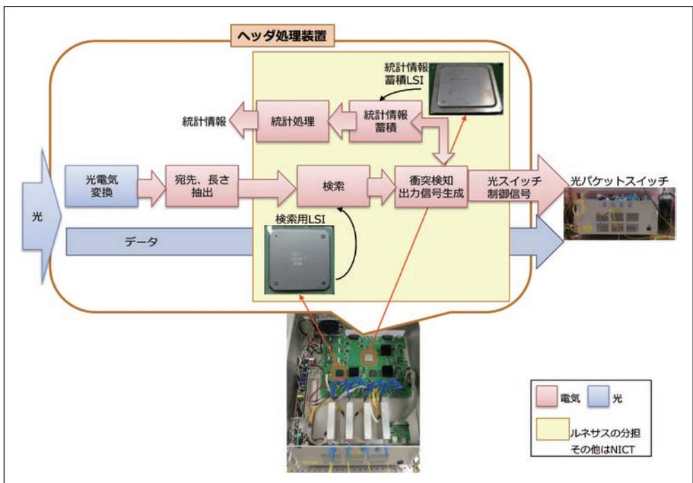
図3 ヘッダ処理装置内部の処理
