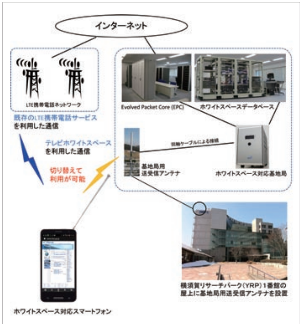
図2 構築したフィールド実験用システム
