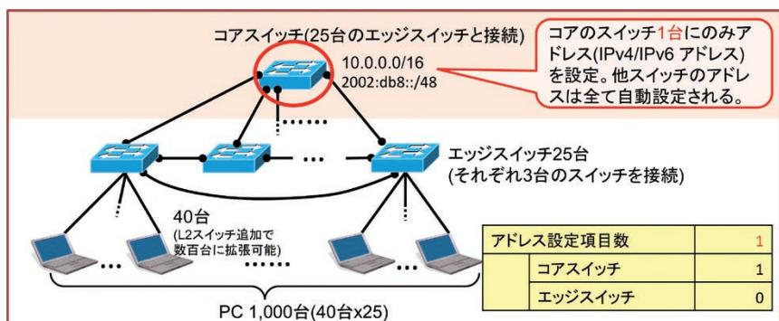
図3 HANA対応L3スイッチを利用したアドレス設定の例
