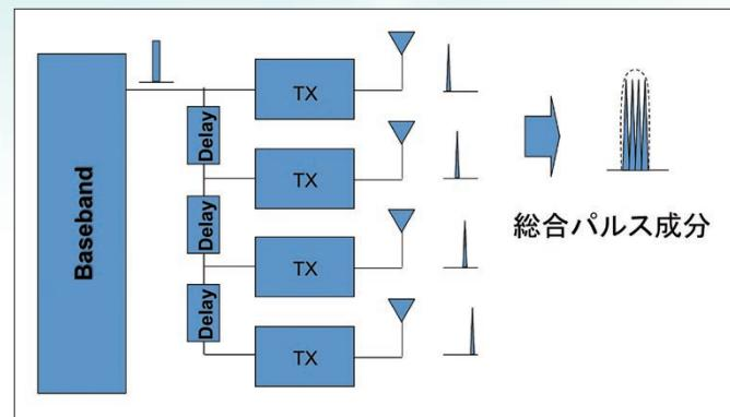
図1 固定機の送信機ブロック図
