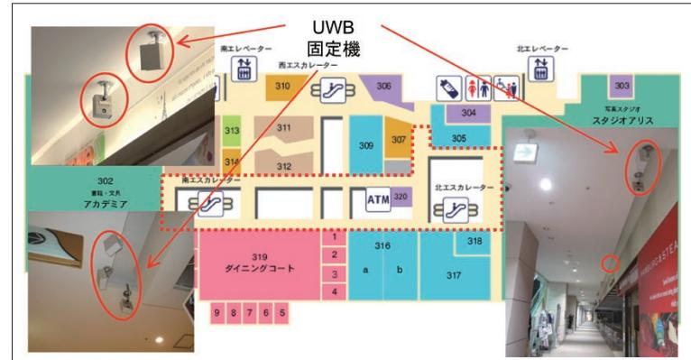
図3 フロアレイアウトと固定機設置例
