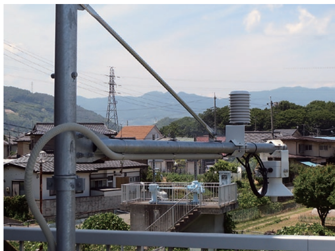
図4 沢山川流域に設置した水位センサー
