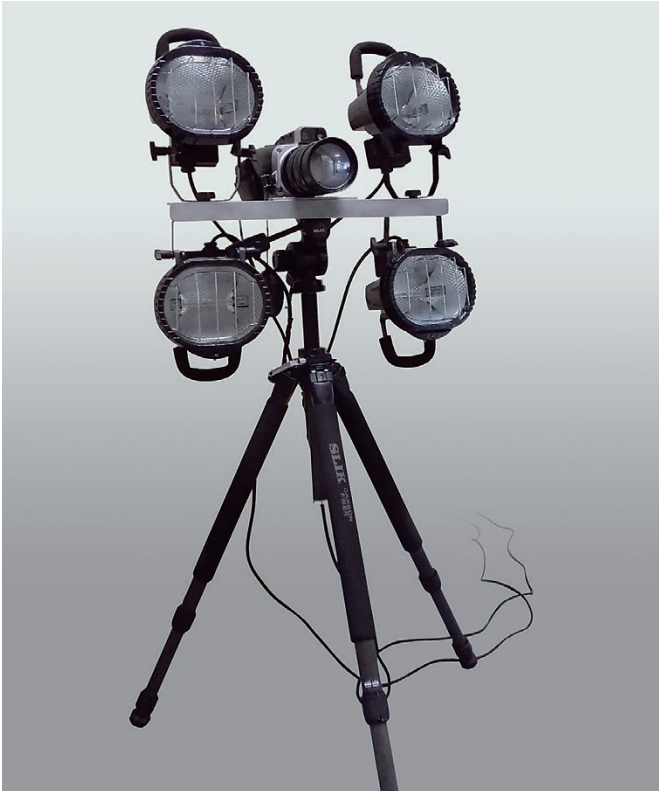
図2 赤外線2次元ロックインアンブ装置
