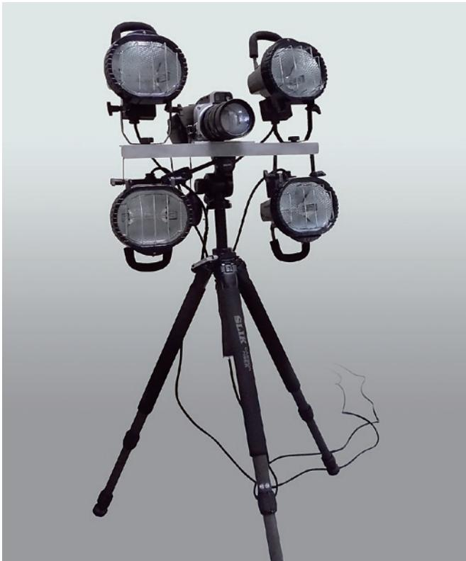
図2 赤外線2次元ロックインアンプ装置
