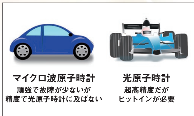
図1 マイクロ波原子時計と光原子時計の比較
