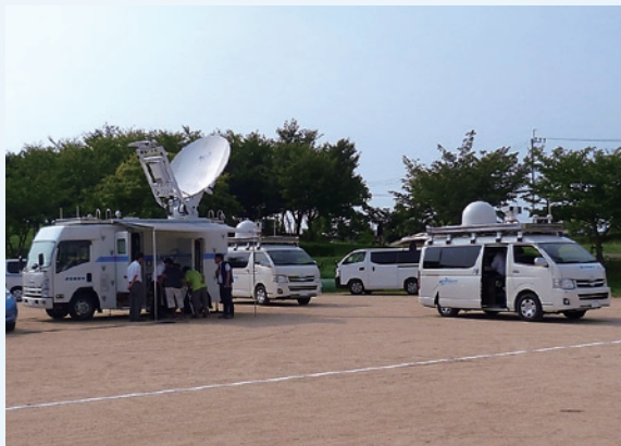
現地対策本部に設置されたWINDS車載局
