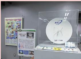
本アンテナは1988年に「西太平洋干渉計プロジェクト」の本土局として設置されたVLBI観測専用です。現在周波数比較プロジェクトの要の局として、3-14GHzの超広帯域の信号を一度に受信できる新しい受信機を搭載し、従来より格段に精度の高いVLBI観測技術の開発に活用されています。
