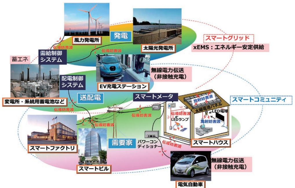
\*1 スマートハウス: IT技術を利用して、太陽光発電システム等からのクリーンなエネルギーの供給と、省エネルギー家電等による電力消費のバランスをネットワークでコントロールし、省エネとCO<sub>2</sub>排出の削減を実現する住宅。
