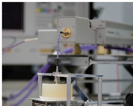
図1 (左) 準ミリ波・ミリ波帯における電気定数測定装置。直径100 mm程度の試料の電気定数を測定する装置。(右) 直径10 mm程度のセンサ型の装置であり、採取量が少ない生体組織の測定に適しています
