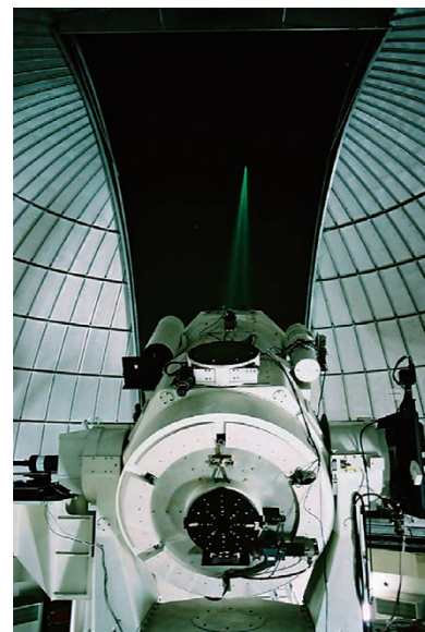
図3 1.5 m望遠鏡による衛星レーザ測距
