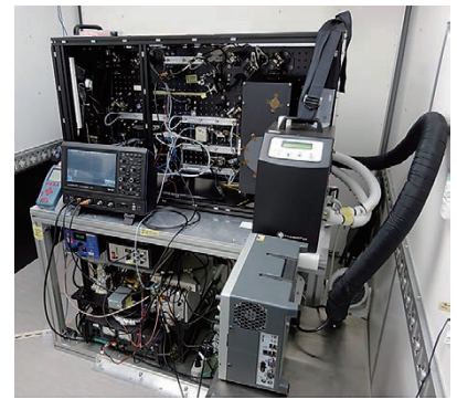
図3 新しく開発された2μmレーザを用いた地上設置型風ライダー。航空機搭載用風ライダーとしても運用可能
