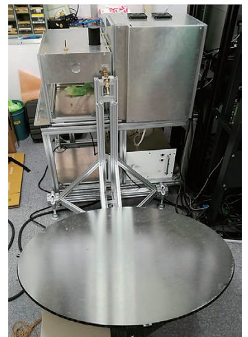
図2 高感度雲観測レーダ (HG-SPIDER) アンテナと送受信器 感度: -40dBZ (1秒積分時、高度15km)
