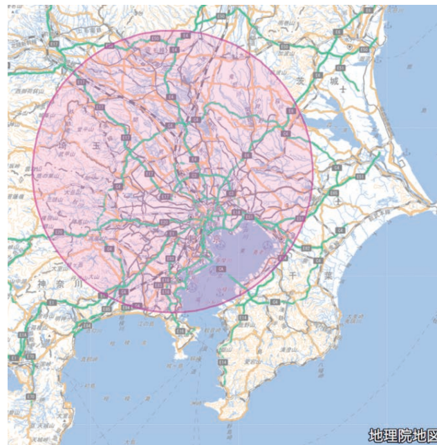
図3 埼玉大学を中心とした半径60Km内の高速3次元観測範囲 国土地理院の電子地形図（タイル）にレーダ観測範囲を追記して掲載
