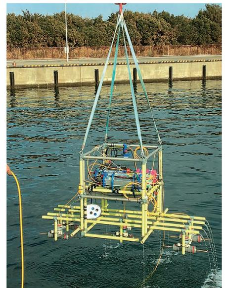
図3 送信アンテナ1台と受信アンテナアレイ4台を搭載したセンシング用測定フレーム
