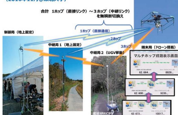
図1 産業技術総合研究所と共同で実施したコマンドホッパーによるマルチホップ伝送実験の様子
