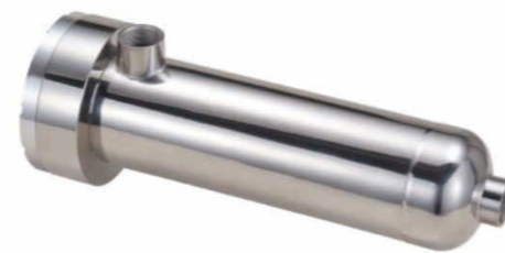
NICTの研究成果の利用例 (深紫外半導体発光素子を利用した水殺菌装置) 深紫外LEDの光取出し効率を大幅に向上させることで、小型・高出力な深紫外LED光源を実現しました。水銀ランプに代わり、殺菌システムでの利用が期待されます。
