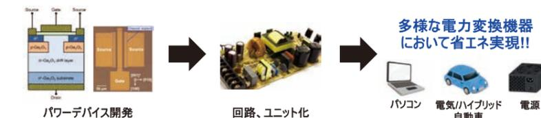
図3 Ga<sub>2</sub>O<sub>3</sub>の特徴、パワーデバイス開発の流れ
