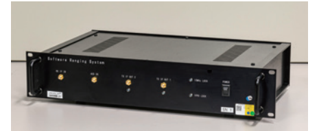
図2 NICTが開発したSRSモデムは、変調コードの位相を使った時刻比較に加えて、搬送波位相を使って17桁の周波数比較が可能である。
