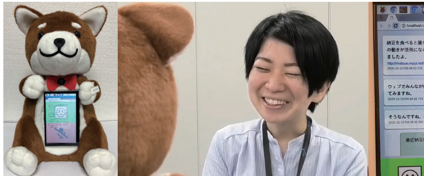
図 MICSUSの柴犬型端末と対話の様子(右側の液晶画面に対話の履歴が表示されている。対話者はNICTのエンジニア) 内閣府SIP第二期にてKDDI株式会社、NECソリューションイノベータ株式会社、株式会社日本総合研究所と共同開発
