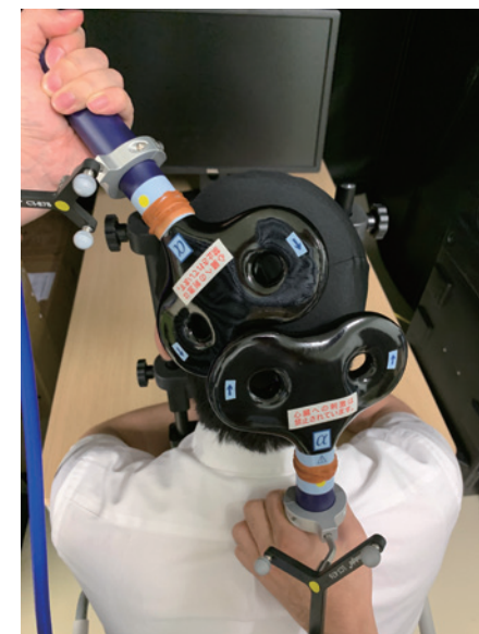
図 経頭蓋磁気刺激による脳刺激実験の様子。頭部に置いたコイルに瞬間的に大きな電流を流すことで、コイル直下の脳領域に電流を誘導することができる。写真は、2本のコイルを使って脳領域間の機能的結合を操作する実験。
