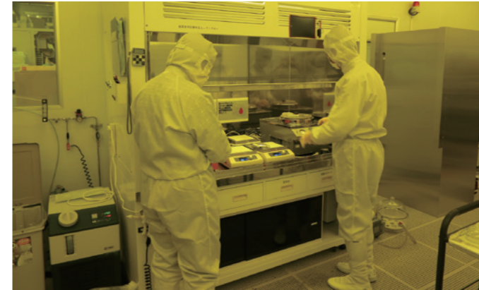
図1 イエロールーム内におけるスタッフの作業風景（フォトレジスト・コーティング作業）
