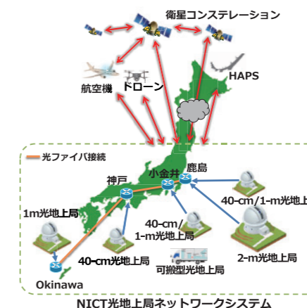
図2 整備中の光地上局ネットワークシステム
