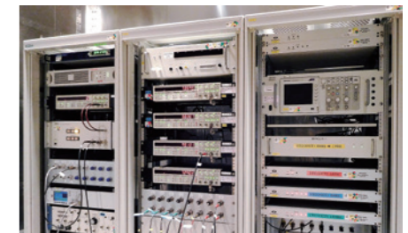
図4 周波数標準器の持ち込み校正システム
