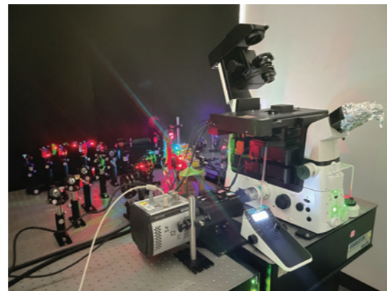
図 蛍光4色を同時に観察できる顕微鏡を構築中
