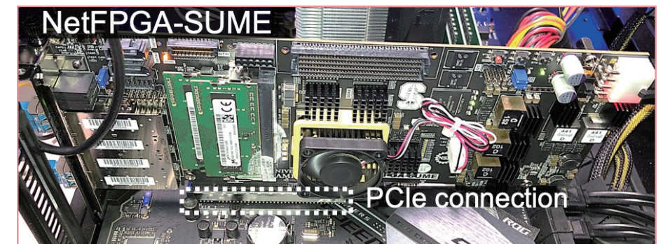
図2 ICN機能を実装したNetFPGA-SUME
