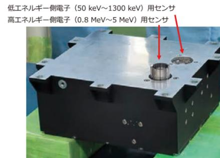
図1 電子線計測装置(RMS-e)エンジニアリングモデルの外観
