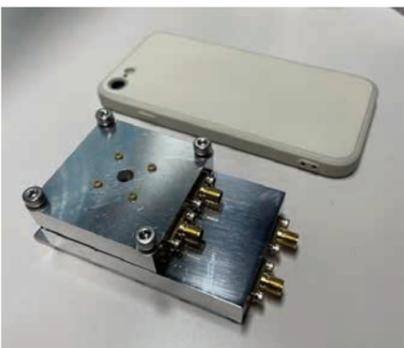
図2 現在開発中の小型帯電計測装置
