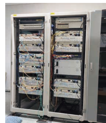
図2 (左) 分散時刻同期の実験装置：10 台の原子時計を光ファイバーで接続し、各時計間の時刻差をリアルタイムに測定して補正を行う制御機構を備えている。 (右) 実験装置 (左) による実験結果：個々の時計は大きくふらつくものの、平均をとることでノイズが大幅に抑えられ、滑らかな時刻信号が得られる。各ユニットは、自身の原子時計と合成時系との差分情報から、この滑らかな時刻信号を再現できる
