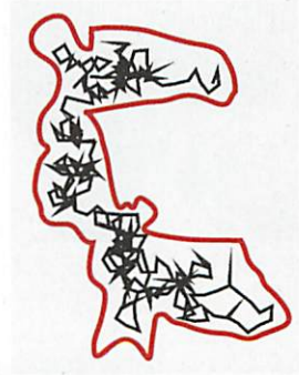
図2 乱数的な動きを持つブラウン回路ロジック空間である回路において、ブラウン運動による乱数的な探索によって、入力から出力までの計算の道が見つけられる。
