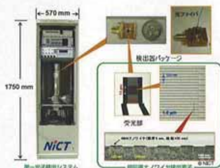
図1 マルチチャンネル超伝導単一光子検出システム (SSPD)、光ファイバを実装した検出器パッケージ、超伝導ナノワイヤ検出素子
