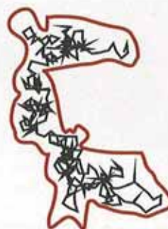
図2 乱数的な動きを持つブラウン回路 ロジック空間である回路において、ブラウン運動による乱数的な探索によって、入力から出力までの計算の道が見つけれれる。
