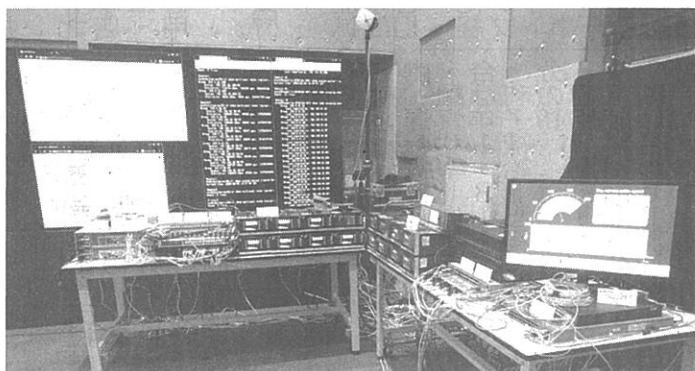
大阪デモ会場での伝送装置と映像受信装置群。右のグラフィックモニターが1秒当たり108ギガbpsを示している
