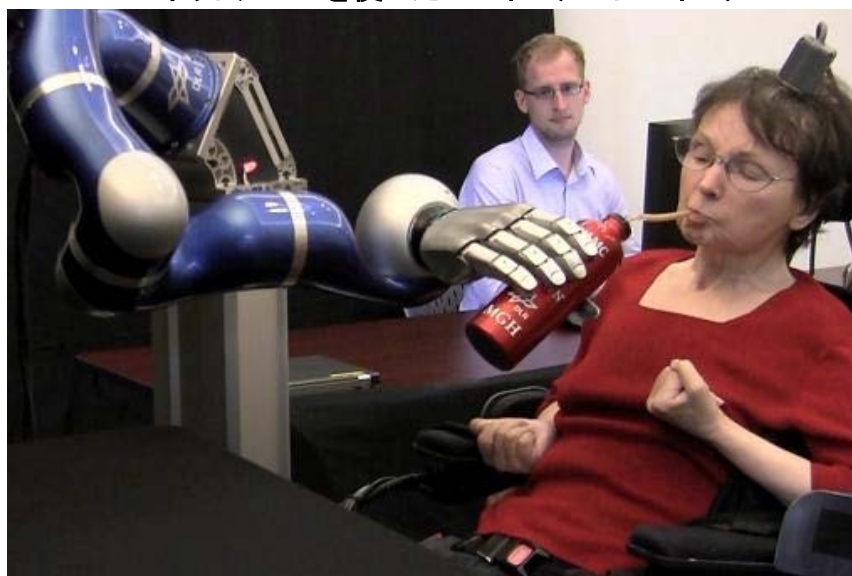
図表 10: DEKA ロボットアームを使ったブレインゲート 2 インターフェースの実演
