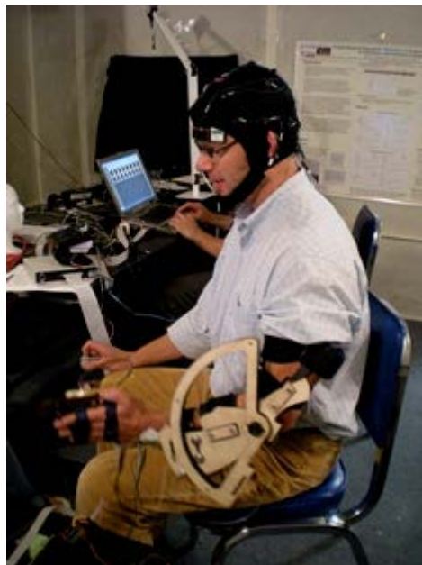
図表 7: EEG 基盤人工装具センサー・システムの試作品
