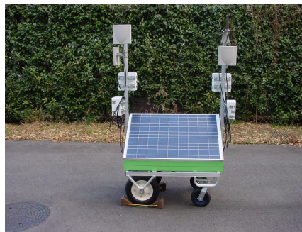
蓄電池(太陽電池により充電)で稼動する基地局
