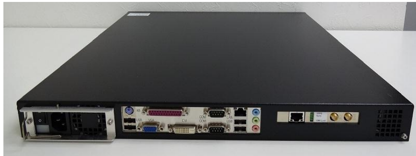
写真：NTPサーバー機能付きGPSコモンビュー装置の外観 上：前面 下：背面
