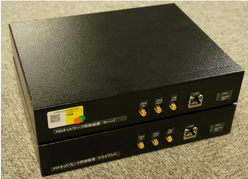
写真:高精度ネットワーク時刻同期装置の外観 上:サーバ 下:クライアント
