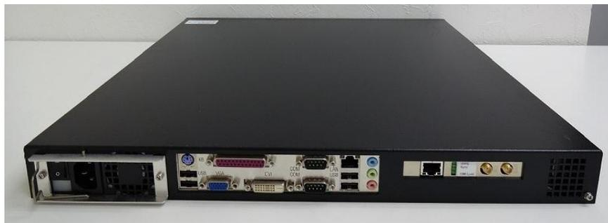
写真：NTPサーバー機能付きGPSコモンビュー装置の外観
