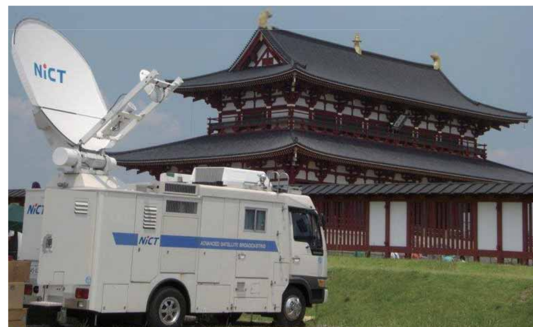
平城京遷都1300年3D映像伝送実験(2010) 世界最高速1.2Gbps(単一搬送波)に成功した通信システムを使用
