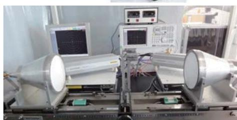
ミリ波帯における生体組織の電気定数測定システム
