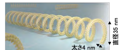
②DNA を材料にした世界最小のコイル状バネ
