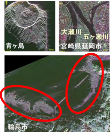
①Pi-SAR X3による観測例（上段：平時のベースマップ、下段：輪島市。赤で囲んだ部分は能登半島地震による隆起で海面から出た部分）。
