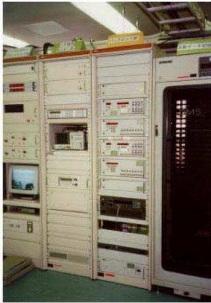
図1:通信総研の開発したK4型VLBI観測装置
