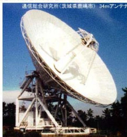
はるか数十億光年の彼方から地球に届く電波星の電波を利用して、何千kmも離れた2点間の距離を、わずか数mmほどの誤差で測るVLBI。この技術によって正確な位置がわかり、これをくり返すことで、プレートの移動や地球の自転の変化を精密に測ることができます。
