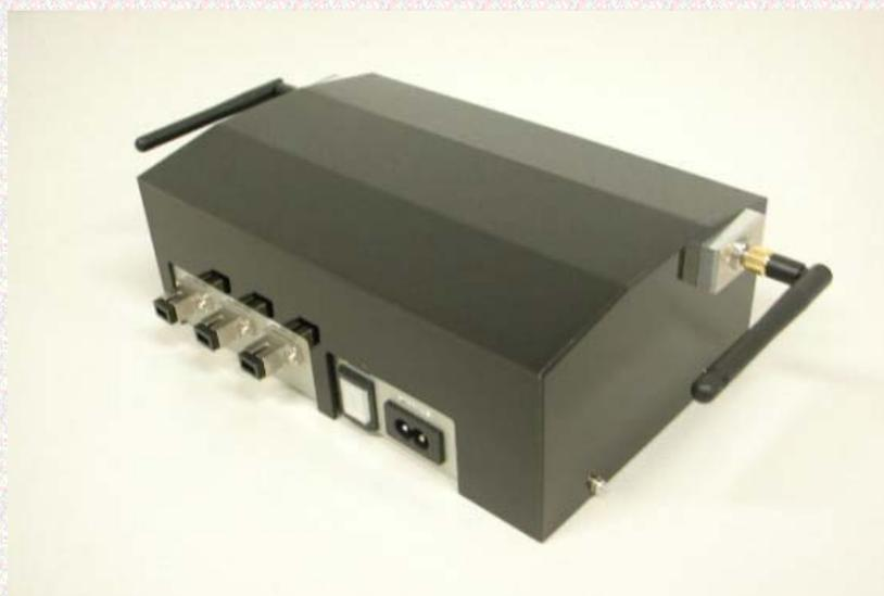
図2 試作した小型アンテナ基地局の外観
