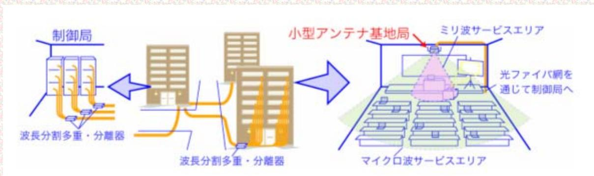
図1 マルチバンド光ファイバ無線サービスのイメージ
