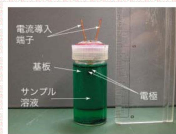
図2: ナノ電気分解用のセルに原料溶液を加え、電極の付いた基板を取り付けて原料溶液に浸している様子
