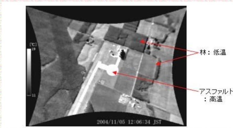
広面角マルチバンドセンサ(熱赤外): 地表面温度分布観測 (高度: 約850m)
