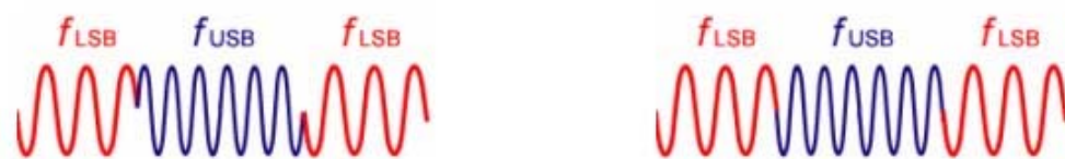
図1 従来の周波数偏移変調方式の場合、光信号が不連続となり(左図)、光信号特性が劣化する。一方、本方式では変調時の信号が常に連続となり(右図)、良好な変調特性が得られる。
