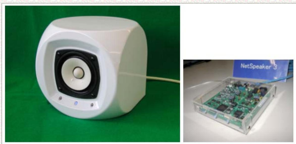
図1 インターネットスピーカ。右写真は、基板型インターネットスピーカ端末で、これにスピーカやステレオを接続して利用します。左写真は、右写真の基板型インターネットスピーカ端末を内蔵したインターネットスピーカです。電源をイーサネットより供給しているため、LANケーブルのみをつなぐことで利用できます。
