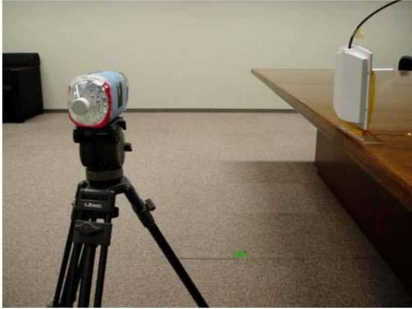
ペットボトルに布製電子タグを取り付けて機能測定を行っている様子
