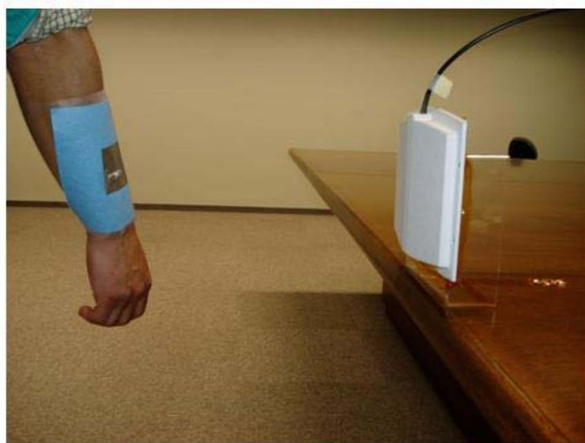
腕に布製電子タグを取り付けて機能測定を行っている様子
