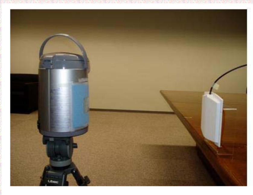
ポット(表面が金属)に布製電子タグを取り付けて機能測定を行っている様子
