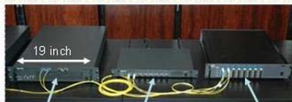
光パケット変換部      アービター部      2x2光スイッチ部
