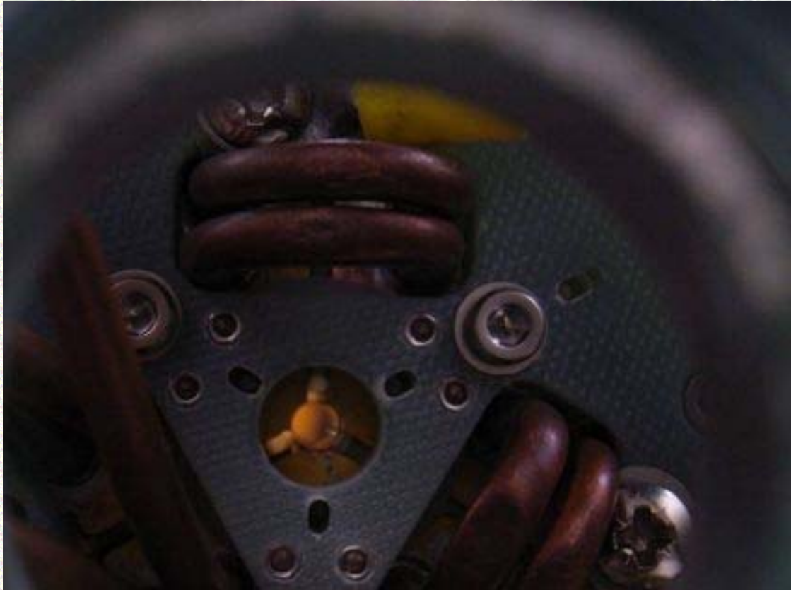
図9 (上)真上からのぞいたレーザーヘッドの様子。レーザーヘッド部は、衛星からの風観測を目指して研究が行われたLD励起伝導冷却型Tm,Ho:YLFレーザー開発で培われたノウハウが活かされている(平成17年5月19日付報道発表*)。(下)レーザーヘッド内部を射出窓からのぞいた様子。やや左下の円内に見える円形部分が、レーザー発振に重要なレーザーロッド。そのレーザーロッドは、ロッド周囲に切られた3カ所の溝からLDによって光が照射され励起される。
