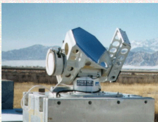
図2 窒化ニオブ(NbN)超伝導受信機を搭載したサブミリ波電波望遠鏡 (中国科学院紫金山天文台)
